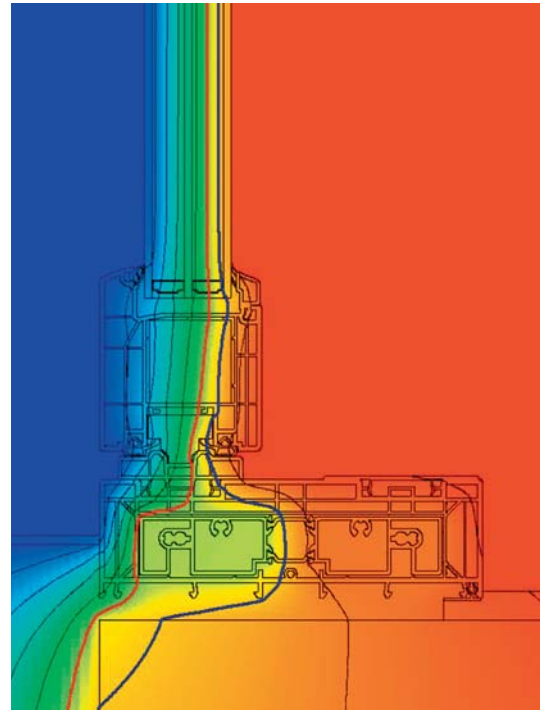
Prikazani tijek temperature naglašava vrlo dobra izolacijska svojstva novih podizno-kliznih vrata GENE0. Izotermički tijek: crveno 10 °C, plavo 13 °C
